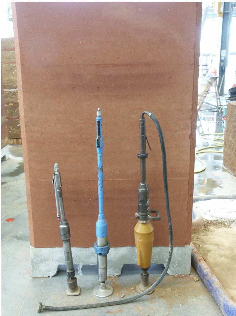
фигура 149 Механични пневматични трамбовки. CRATERRE
