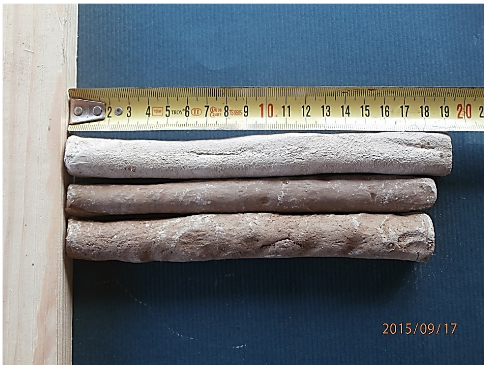
Фигура 33 Тест за определяне свиването при изсъхване. Приготвя се руло с дължина 20 см с необходимото оптимално водно съдържание за съответната строителна техника. След пълното му изсъхване се измерва дължината и по разликата се отчита свиването. Например ако рулото е дълго 18 см, т.е свиването е 2 см или 10%.
