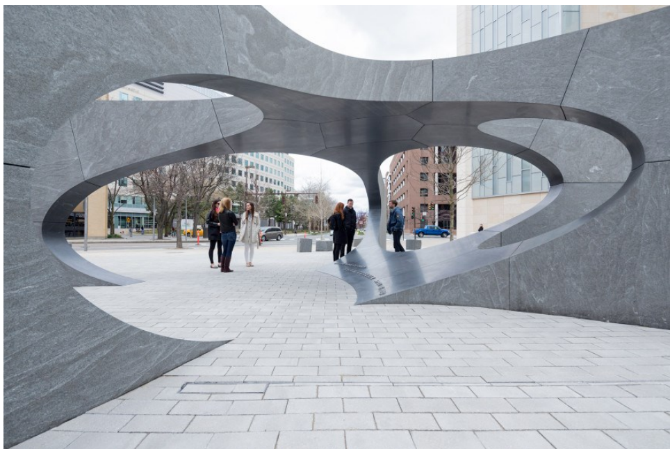
Фигура 252 Хай-тек конструкция от гранит. Паметникът се състои от 32 масивни гранитни блока, прецизно оформени с компютър и монтирани заедно в плитка отворена куполна арка с 5 радиални крила, наподобяваща пръстите на отворена ръка Collier Memorial , Бостън, САЩ. Архитект J. Meejin Yoon
