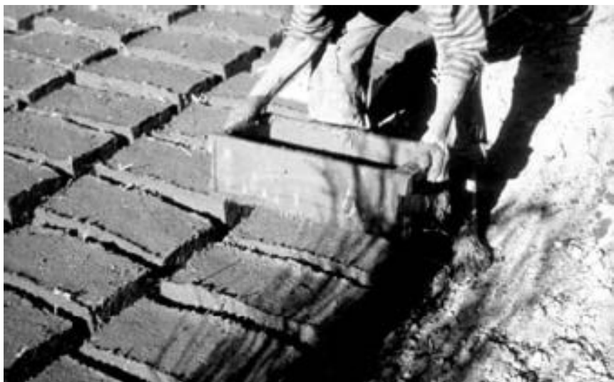
фигура 75 Работа с единичен калъп без дъно. [7]
