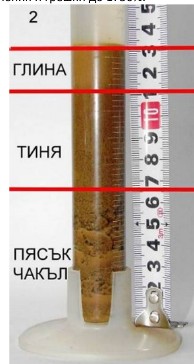
Фигура 30 Седиментен тест. Наблюдава следния състав. ГЛИНА 15%; ТИНЯ 35%; ПЯСЪК И ЧАКЪЛ 50%
