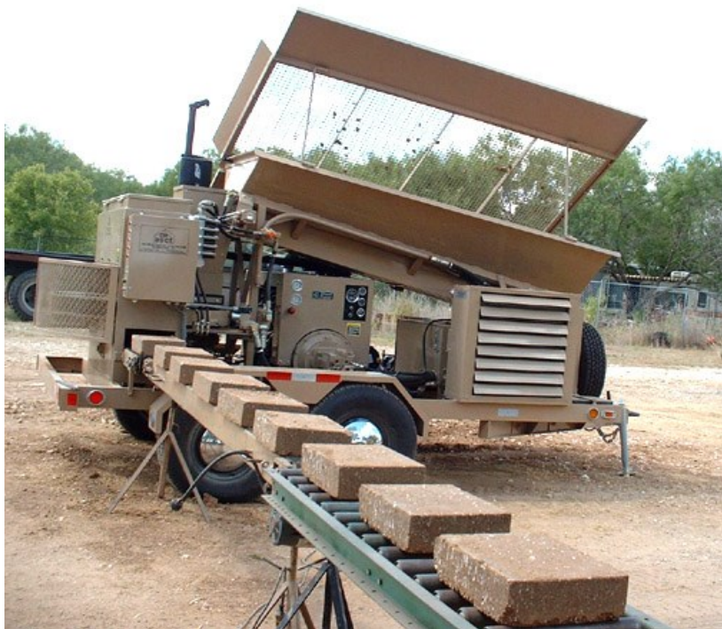
фигура 79 Механична преса за глинени блокове.
