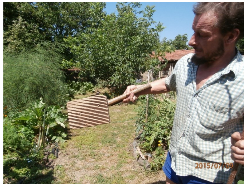
Фигура 211 Специален инструмент, дървена лопата за набиване и изравняване на сламата.
